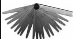
Щупы измерительные Для измерения зазора клапанов двигателя от 0.05 до 1.00 мм. Материал: инструментальная сталь.
